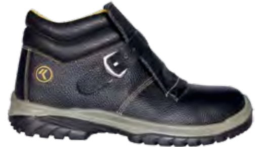
36140 EBR0 EN ISO 20345 S3 SRC Chaussure haute pour soudeur avec tige en cuir aspect grainé, large rabat par-dessus la languette (élastique sans lacets), fermeture avec boucle métallique pour un déchaussement rapide. Coutures en fibre aramide qui garantissent une meilleure résistance, mais aussi une protection contre les étincelles de soudage. Semelle en PU double densité.
